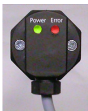
Eine kleine LED Anzeige am Sensorkopf dient zur Funktionsüberwachung und schnellen Fehleranalyse vor Ort.
