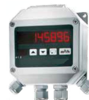
Optional: LED-Wandanzeige zur Visualisierung direkt vor Ort. Anzeige: m/s oder m³/h, programmierbares Ausgangssignal, zwei programmierbare Relaisausgänge, Spannungsversorgung 85 – 230 V AC, Spannungsversorgung des angeschlossenen Sensors, Extraversion mit Summenfunktion.
