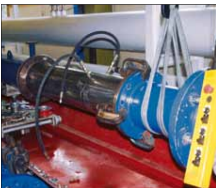
Abb. 4: Wichtig ist, dass die komplette Messkette als Einheit be- trachtet und geprüft wird. Die Einzelprüfung der Komponenten ist bei Weitem nicht ausreichend.
