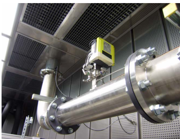
Druckluftmessung in einem Turboladerprüfstand eines italienischen Sportwagenherstellers
