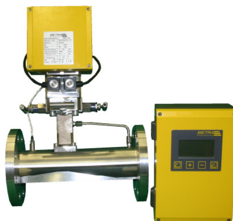
EDZ / EWZ 157.1 kompakt, mit klassischem Venturirohr und separatem Rechenwerk ERW 700
