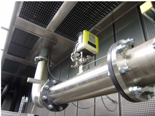
Druckluftmessung in einem Turboladerprüfstand eines italienischen Sportwagenherstellers
