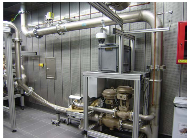
Druckluftmessung in einem Turboladerprüfstand eines italienischen Sportwagenherstellers
